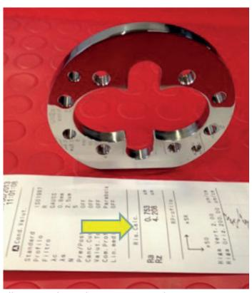
Alle Innenteile werden mit einem Rauheitswert unter 0,8 Ra bearbeitet und poliert.
